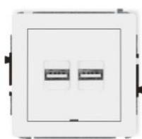
DCUSBBO-6 Mechanizm ładowarki USB podwójnej 2xUSB A, 15,5W max., 5V, 3.1A, bez pola opisowego biały / White double USB charger mechanism 2xUSB A, 15,5W max., 5V, 3.1A, without description field
