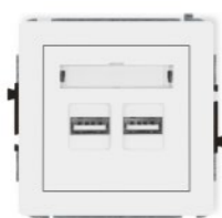
DCUSB-6 Mechanizm ładowarki USB podwójnej 2xUSB A, 15,5W max., 5V, 3.1A biały / White double USB charger mechanism 2xUSB A, 15,5W max., 5V, 3.1A
