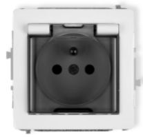
DGPB-1zdp Mechanizm gniazda bryzgoszczelnego z uzziemieniem 2P+Z (kłapka dymna, przesłony torów prądowych) biały / White splash proof socket with the 2P+Z earth mechanism (shaded transparent cover, with increased contact protection/shutter)
